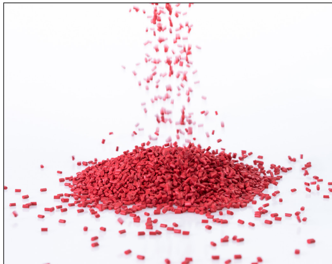
Abb. 2: Kunststoffgranulat zum Spritzgießen oder für die Extrusion
